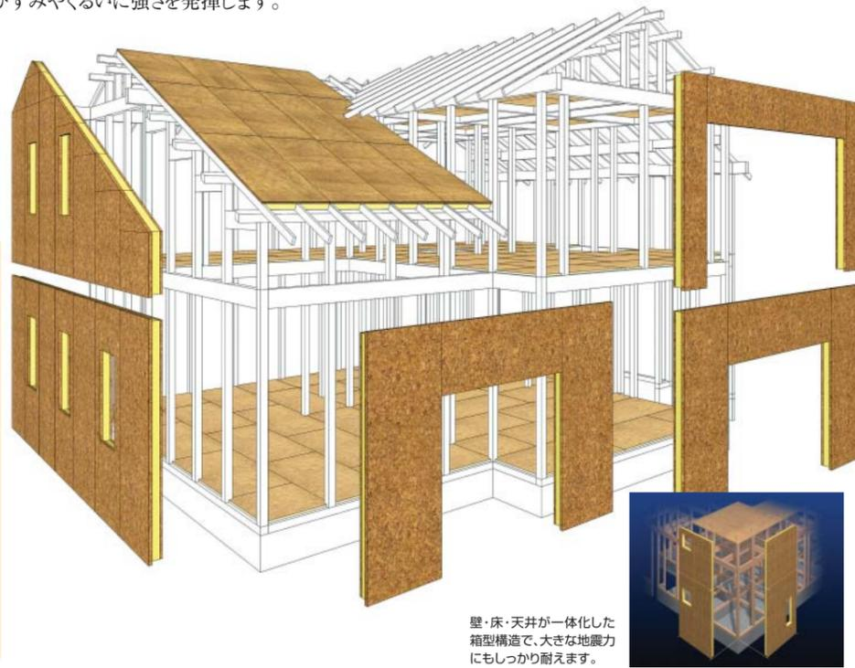
壁・床・天井が一体化した箱型構造で、大きな地震力にもしっかり耐えます。
